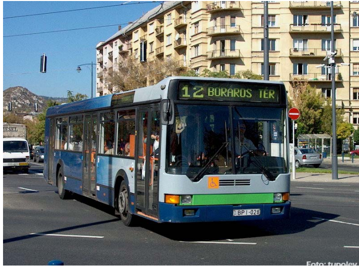
4. kép Ikarus 412 típusú alacsonypadlós autóbusz FOK-GYEM utastájékoztató rendszerrel
